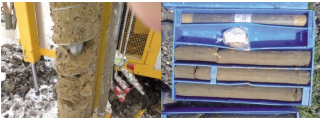
FIGURA 3. Aspecto de las "glinas" en sondeos helicoidales y en los sondeos de rotación.
