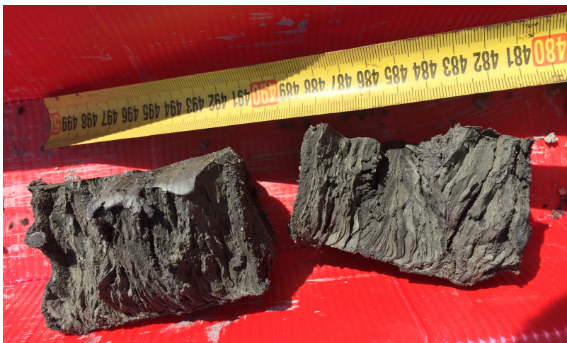
Figura. 2. Vista de una muestra de testigo extraída en el material ensayado.
