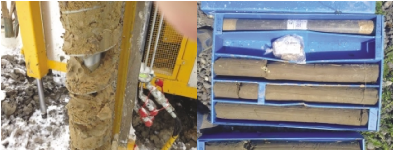
FIGURA 1. Aspecto de las “glinas” en sondeos helicoidales y en los sondeos de rotación.
